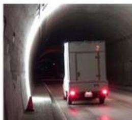
走行型高精度画像計測システム (トンネルトレーサー)
