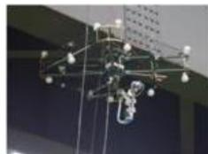
マルチコプターを利用した「橋梁点検カメラシステム 視る・診る」による近接目視、打音調査等援助・補完技術
