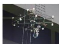
マルチコプタを利用した「橋梁点検カメラシステム 見る・診る」による近接目視、 打音調査等援助・補完技術
