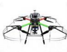
マルチコプターによる 近接撮影と異状箇所の 2次元計測
